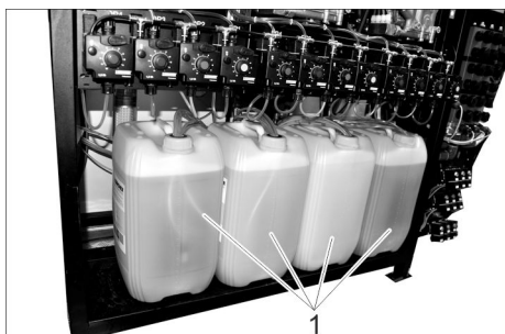
1 Каністра для миючого засобу Гарячий віск Високоякісний догляд Видалення бруду Миття під високим тиском / волога піна
