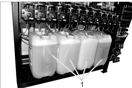
1 Behållare rengöringsmedel Hetvax Toppvård Smutsborttagning Högtryckstvätt/Våtskum
