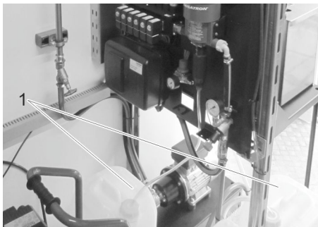
1 Bidón de detergente Pulido Espuma
