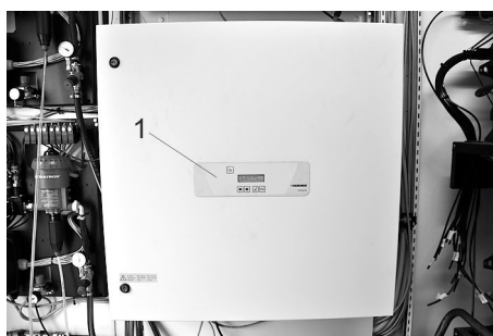
1 Wskaźnik usterek w wyświetlaczu układu sterowania
