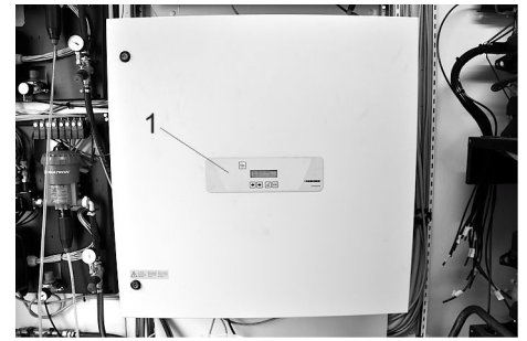
1 Indicador de avería en la pantalla del control
