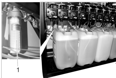
1 Фильтр насоса защиты от замерзания
