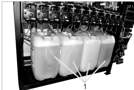
1 Bidon de détergent Lavage haute pression / mousse humide Cire chaude Lavage à la mousse Détachement de saletés Top finition
