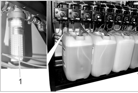
1 Фільтр насоса для захисту від замерзання
