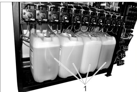
1 Bidón de detergente Cera líquida Cuidado final / Abrillantado Eliminación de suciedad Lavado de alta presión/espuma húmeda
