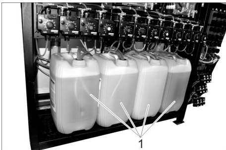
1 Reinigungsmittelkanister Heißwachs Top-Pflege Schmutzlösen Hochdruckwäsche / Nassschaum
