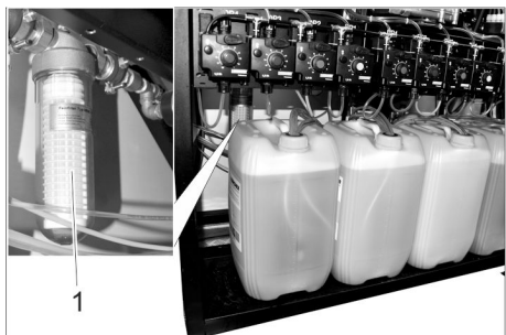
1 Фільтр насоса для захисту від замерзання
